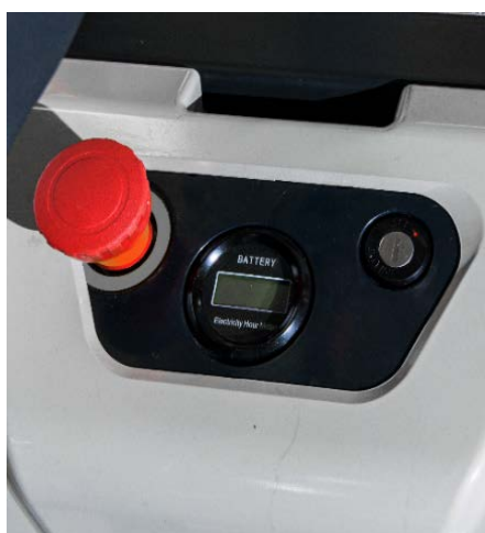
Аварийная кнопка, индикатор заряда и ключ зажигания в зоне видимого контроля оператора
