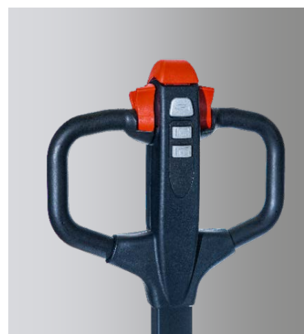
Кнопка защиты оператора и груза для безопасной работы в узких коридорах
