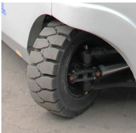
4 точки опоры с глубоким протектором и усиленным рычагом, обеспечивают более высокую грузоподъемность.
