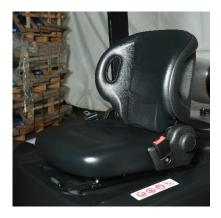
Встроенный в сиденье датчик присутствия не позволит погрузчику передвигаться без оператора.
