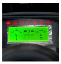
Многофункциональная LED панель со счётчиком моточасов для контроля своевременного технического обслуживания.
