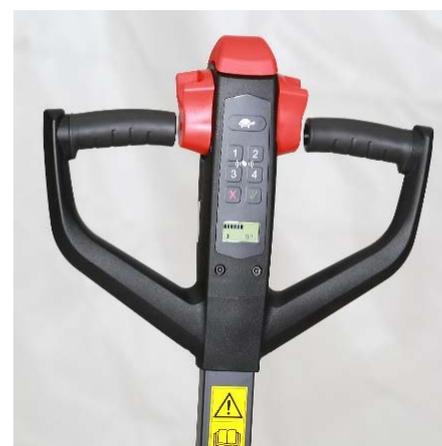
Кнопка защиты оператора для безопасной работы. Функция «черепаший ход» для защиты оператора и груза в узких коридорах
