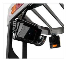
TISEL FORKVIEW SYSTEM – система видеоконтроля с 7 дюймовым цветным монитором высокой четкости для отслеживания положения вил.
